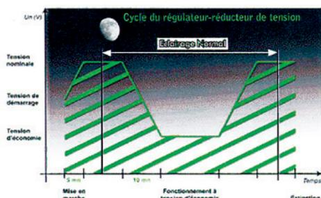
Afin de diminuer la consommation d'énergie, nous avons **modernisé l'éclairage public**. La pose de régulateur-réducteur de tension permet d'abaisser la luminosité pendant la nuit à partir de 21 heures. Ces appareils contribuent également à la protection des lampes et engendrent des économies de maintenance sur le réseau. Nous espérons ainsi une économie budgétaire de l'ordre de 20%. Enfin cette modernisation écologique va dans le sens d'une réduction des nuisances lumineuses nocturnes.
